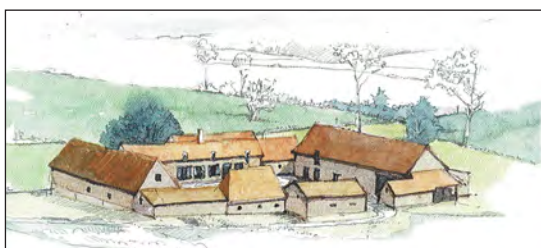
Ferme en briques, à cour carrée, murs en briques, pannes flamandes anciennes, lucarnes passantes, portes et fenêtres à impostes, symétrie des ouvertures.
